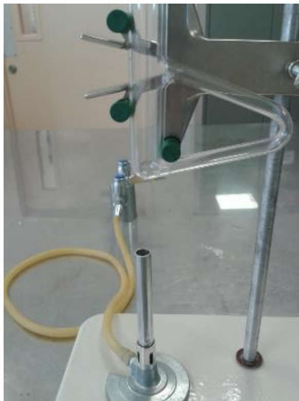
Figura 2. Mechero Bunsen debajo de tubo Thiele
