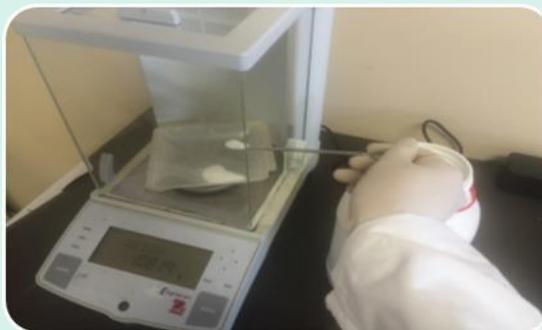
**Figura 8.** Pesado del polímero en balanza analítica.
