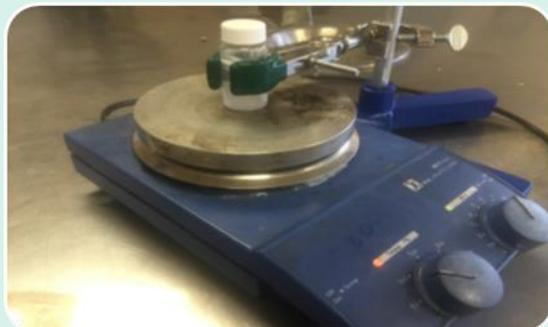
**Figura 9.** Ajustar el vial de vidrio con el soporte universal y colocar el agitador magnético dentro del vial y agitar a 200 rpm.
