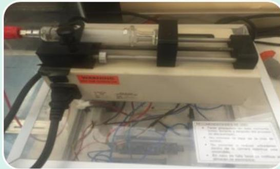
**Figura 12.** Jeringa cargada en la bomba de inyección.
