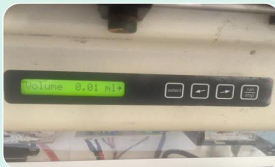
**Figura 13.** Programar el flujo de inyección en la bomba.
