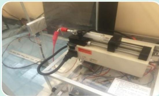
**Figura 16.** Colocar los electrodos e iniciar el sistema de electrohilado. El colector debe estar a una distancia de 10 cm con el inyector.
