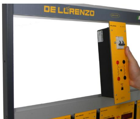
Figura 2 Instalación de un módulo en el armazón del entrenador.
