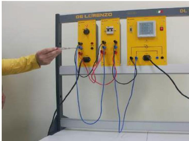
Figura 1 Prueba para revisar la conexión correcta de la fase.
