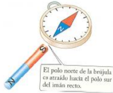
Figura 2. Una brújula cerca de un imán recto.
