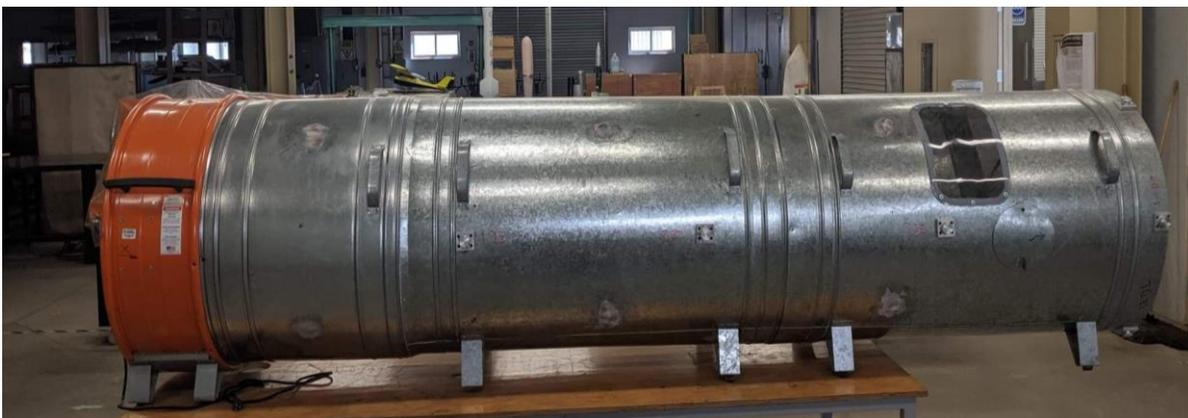
Figura 1.- Túnel de viento circular de FCITEC-UABC
