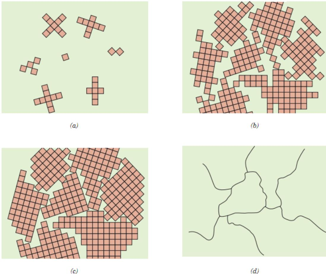
**Figura 3:** Formación de granos por solidificación (a) Se muestran los pequeños cristales iniciales dentro de la formación. (b) Los pequeños cristales crecen y se agrupan con otros cercanos. (c) Formación de granos completos. (d) Representación de los granos vistos en el microscopio (3).
