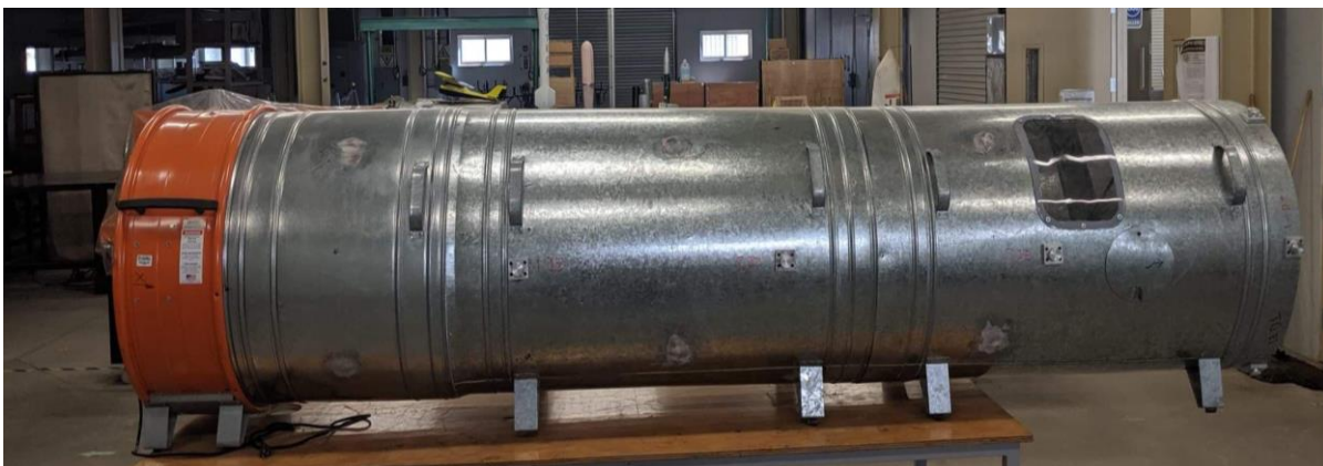
Figura 1.- Túnel de viento circular de FCITEC-UABC
