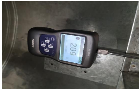
Figura 6. Dinamómetro instalado dentro del túnel de viento.
