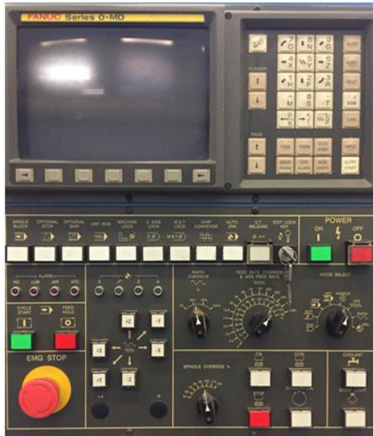
Figura 1. Controlador de maquina cnc.
